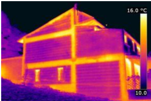
Figura 9 i 10: termografia i condensació d'aigua per contrast tèrmic
